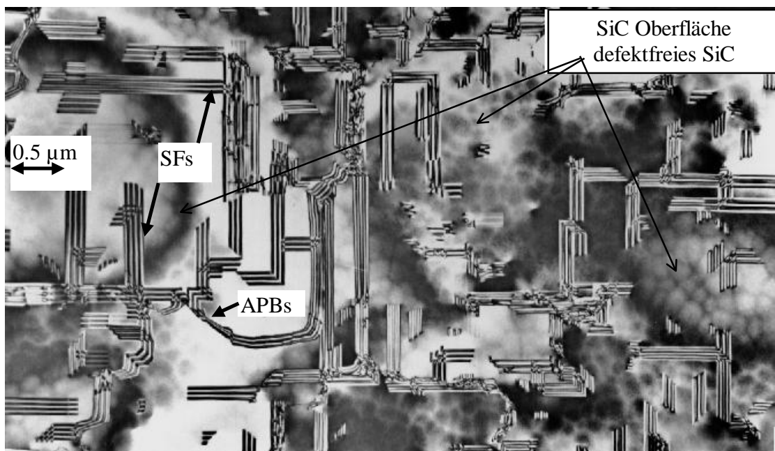
Abbildung 4-7: PV-TEM Aufnahme der SiC Oberfläche
