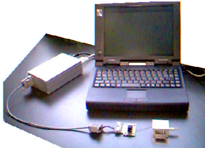
Abb. 4.10: Multigassensoreinheit mit Sensormeßkammer und Laptop-Anschluß zur Steuerung und Datenaufnahme
