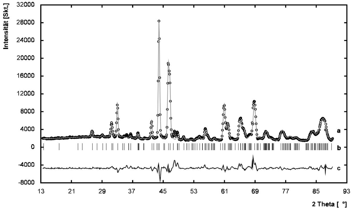
**Abb. 5.15** Neutronenbeugungsdiagramm von  $\alpha$ -Cr<sub>2</sub>P<sub>2</sub>O<sub>7</sub> bei 30 K. a) "o" beobachtete Messpunkte, graue Linie: berechnetes Diagramm; b) Bragg-Positionen der Reflexe; c) Differenzprofil  $I_0 - I_c$ .
