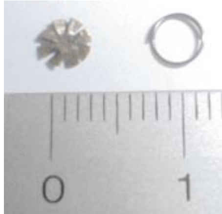
Abbildung 4.20: Bild des Flügelrads aus Kupfer (links oben) zur künstlichen Wirbelbildung am kalten Pulsrohrende zusammen mit einem Sprengring (rechts oben) zum Fixieren, darunter eine Millimeterskala
