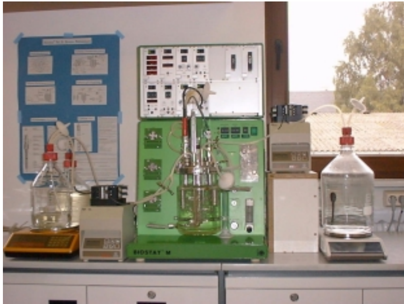
Abbildung 3-2: Aufbau des kontinuierlichen Bioreaktors mit den Flaschen für den Mediumzulauf und der Mediumablaufflasche jeweils auf einer Digitalwaage und den beiden peristaltischen Pumpen.
