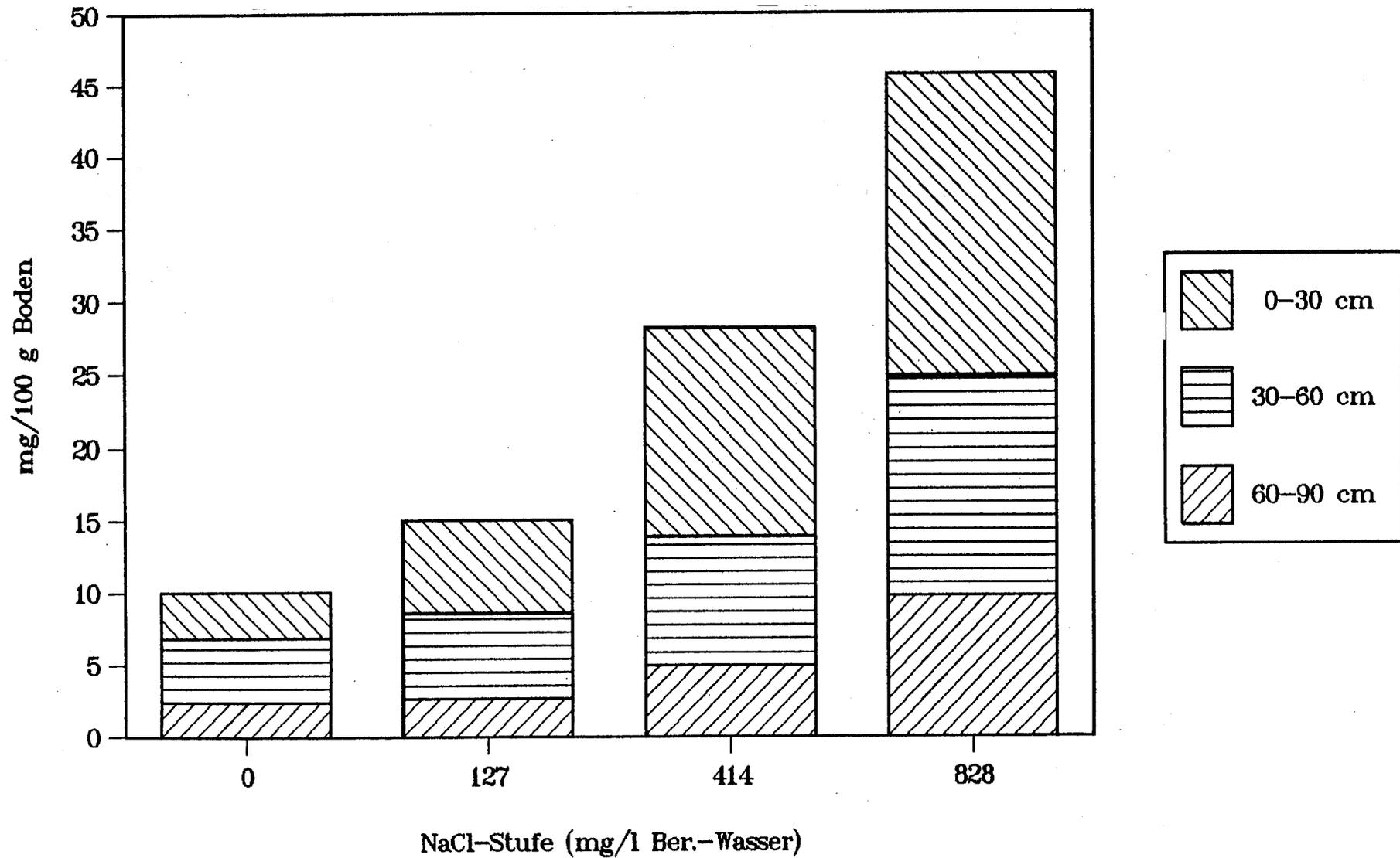
**Abb. 34: Verteilung des durch die EUF-Methode insgesamt zu extrahierenden Natriums in unterschiedlichen Bodentiefen von Salinitätsversuch III (Alt)**
