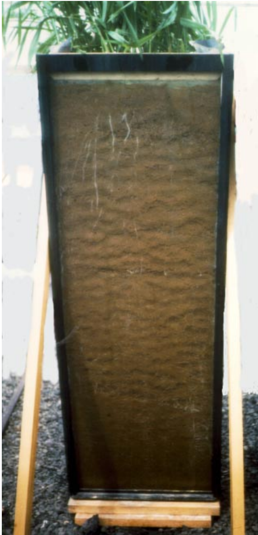
Abb. 38: "Wurzelkasten" zur Untersuchung der Durchwurzelung von Versalzungshorizonten in unterschiedlich tiefen Bodenschichten
