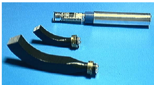
Abbildung 2.10: Photomultiplier (oben) mit Lichtleitern (mitte und unten)
