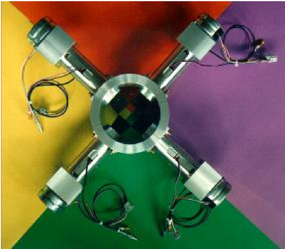
Abb. 2.9: Ansicht eines Halo - Detektor - Teilsystems. Vier der Szintillationsmodule aus Abbildung 2.8 sind in einem speziell angefertigten Aluminium - Rohr montiert, welches in die Strahlführung eingebracht wurde. Jedes einzelne Modul war mit einem Schrittmotor senkrecht zum Strahl positionierbar. Die Öffnung besaß eine maximale Fläche von 36 \cdot 36\text{mm}^2 oder konnte komplett geschlossen werden.
