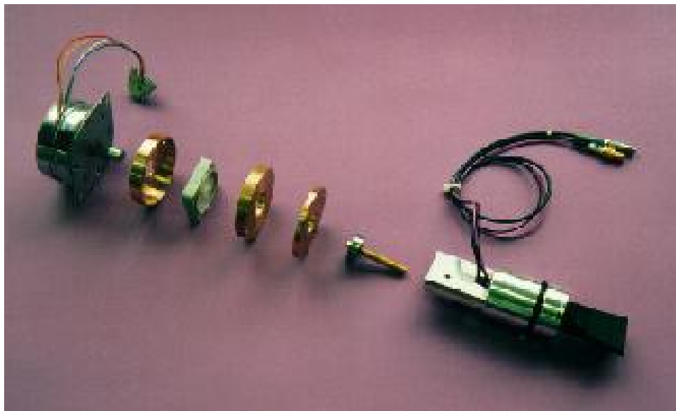
Abb. 2.8: Ansicht eines Halo - Detektor - Moduls. Das Szintillationsmodul aus Abbildung 2.6 befindet sich in einem Metallkolben, welcher mit Hilfe der abgebildeten Welle und des Planetengetriebes von dem Schrittmotor bewegt werden konnte.
