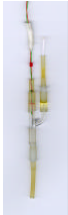
Abb. 3-16: U-Stück für die Messung der Temperatur in der Flüssigkeit
