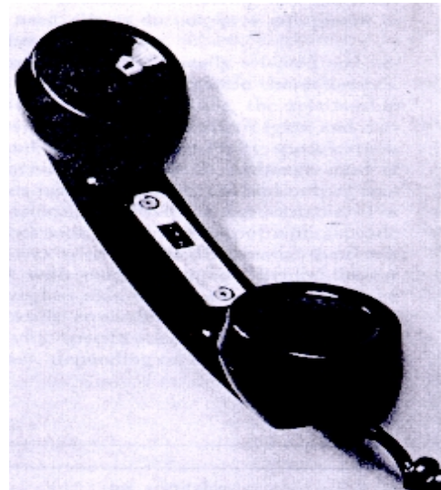
Abb. 2.3.3/1 Telefonverstärker von Bell Canada. Die Verstärkung kann mit Hilfe des Potentiometers in der Mitte des Hörers verstellt werden. (nach Pichora-Fuller, 1981)
