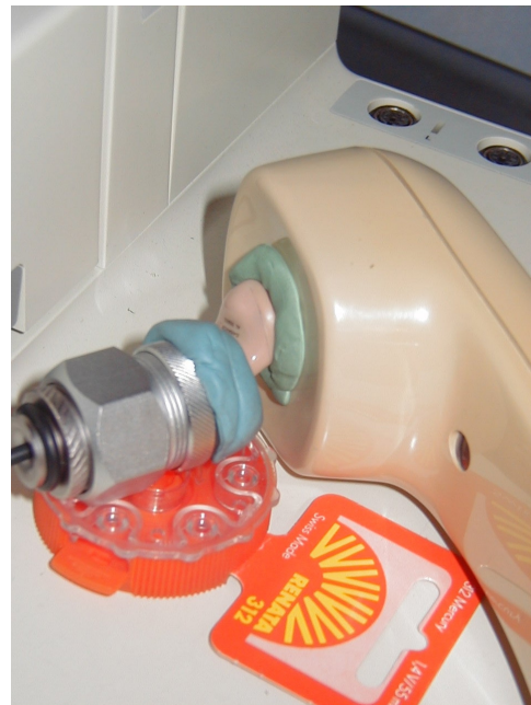
Abb.6.2.1.7 Messaufbau zur Messung der Verstärkung am 2ccm Kuppler für die Einstellungen mit Telespule (Danalogic-IO-TELE, Danasound-IO-TELE)
