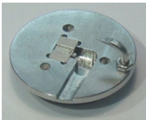
Abbildung 3.10.: Transferteller zum Einschleusen des Hebelarms in die Vakuumkammer und zur dortigen Justage.
