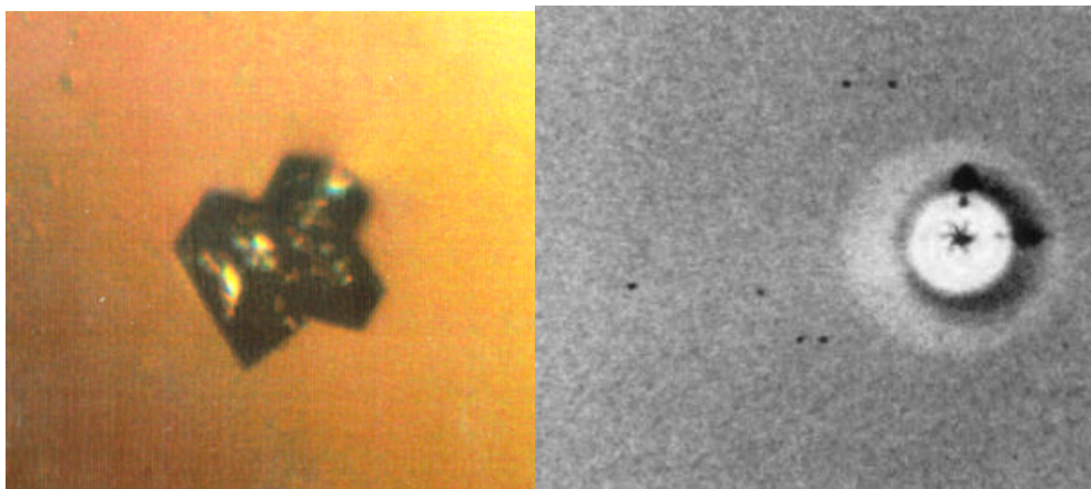
Abbildung 4-1 Links: Bild der CGBG-Kristalle; Rechts: Die Bragg-Reflektion der Kristalle zeigt ein einheitliches Muster. Kristallisationsbedingung: 50 mM MES pH 6,5 , 5 mM Zinksulfat, 12.5% v/v Polyethylene Glycol Monomethyl Ether 550, Methode: Vapor Diffusion
