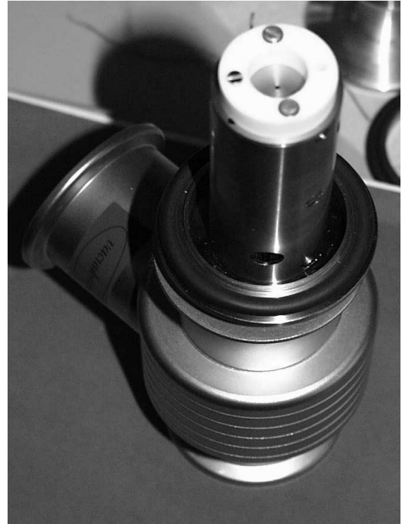
Abbildung 6.3 : Darstellung mit aufgesetzter Probenhalterungsmimik. In der Mitte ist das Einschubloch zu erkennen.
