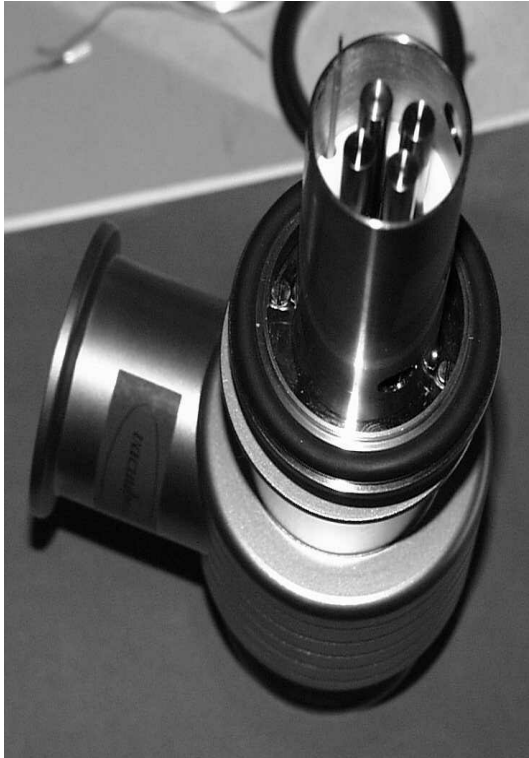
Abbildung 6.1 : Abbildung des Quadrupolmassenspektrometers. Bei abgenommener Ionisierungseinheit erkennt man das darunter liegende Quadrupol-Stabsystem.
