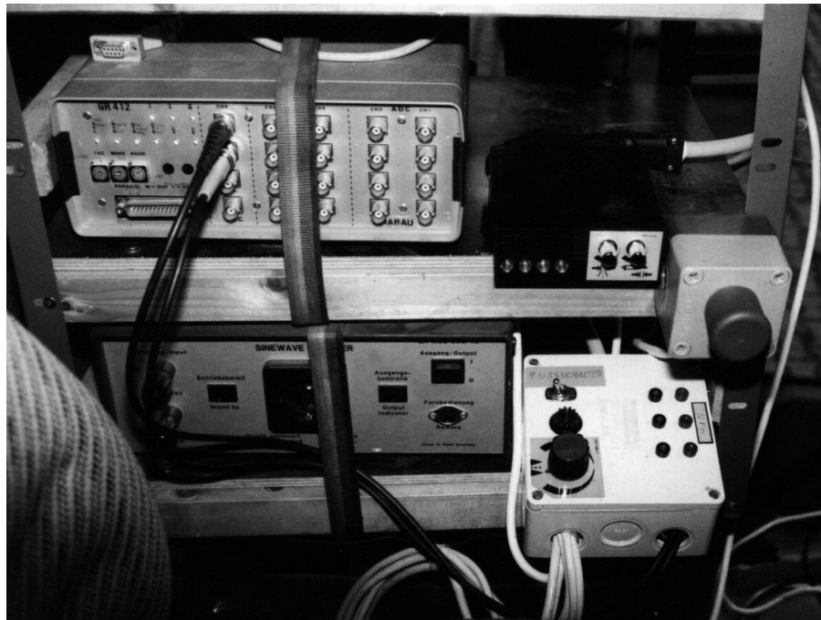
Abbildung 4.10: Komponenten des Autopiloten im Versuchsträger
