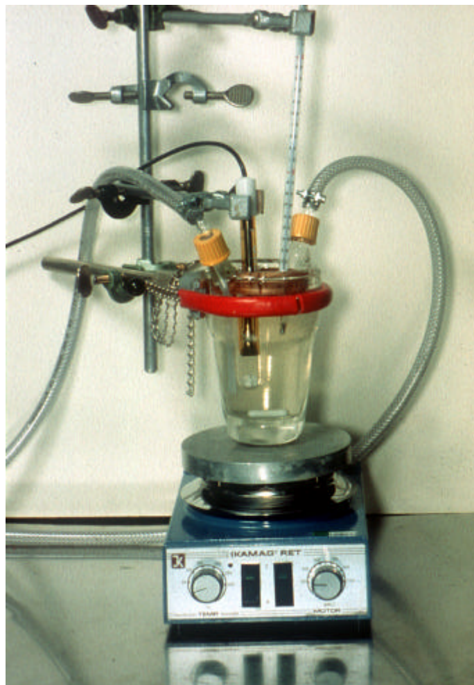
Abbildung 5: Messapparatur mit eingebrachter ionenselektiven Elektrode
