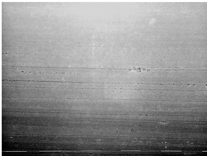
Abbildung 6: Bow-Flex Wire .016“; Ausschnitt aus Abbildung 5 (ein weißer Strich entspricht einer Strecke von 10 \mu\text{m} )
