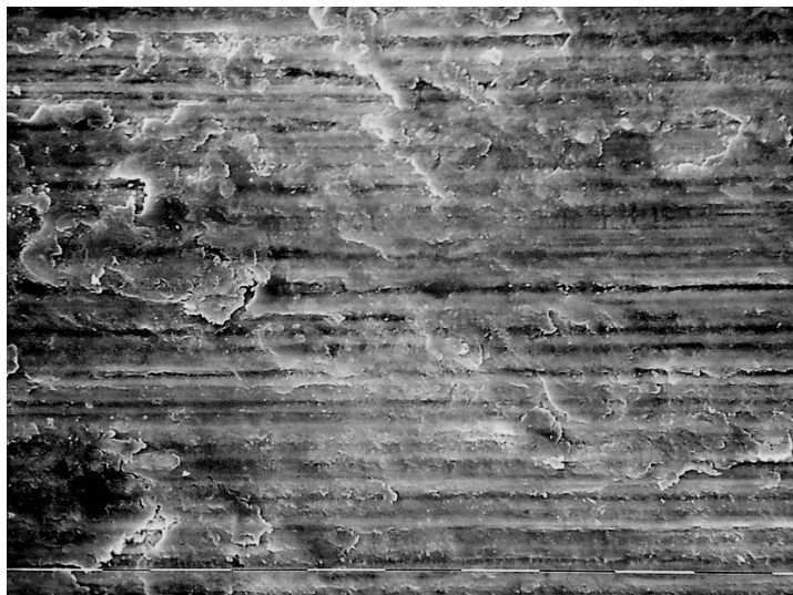
Abbildung 16: Australian Wire Spule special plus .020“; Ausschnitt aus Abbildung 15 (ein weißer Strich entspricht einer Strecke von 10 μm)
