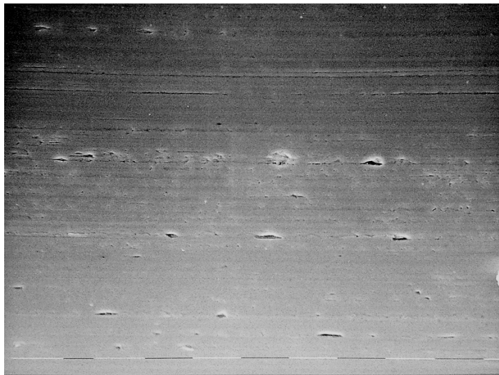
Abbildung 10: TP Original Wire Spule premier plus .016“; Ausschnitt aus Abbildung 9 (ein weißer Strich entspricht einer Strecke von 10 \mu\text{m} )
