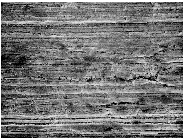
Abbildung 14: Australian Wire Spule special plus .016“; Ausschnitt aus Abbildung 13 (ein weißer Strich entspricht einer Strecke von 10 \mu\text{m} )
