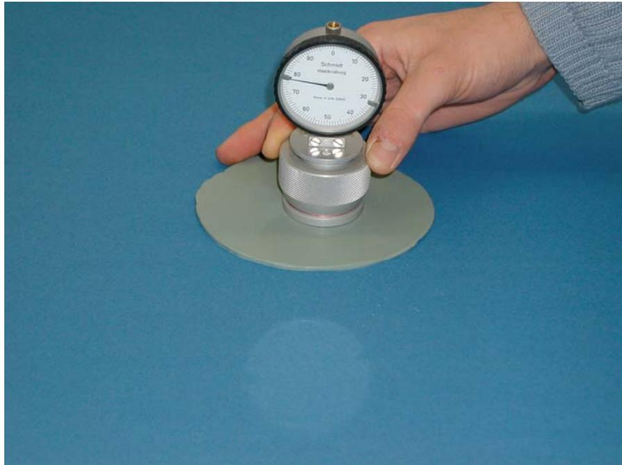
Abb. 12 Messuhr mit Prüfkörper
